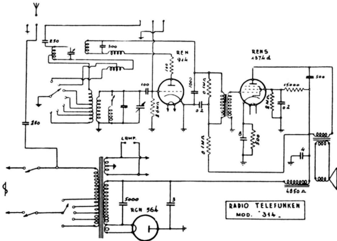
Rivelatrice in reazione seguita dalla finale di potenza. - Gamma d'onda: corte e medie. - Scala parlante a due colori. - Filtro ausiliario per la eliminazione della locale. - Consumo: 40 watt. - Tensione di placca della rivelatrice: 140 v., della finale: 240 v. - Tensione schermo della finale: 200 v.; tensione al catodo: 13 v. - Tensione alla placca della rettificatrice: 500 v.
